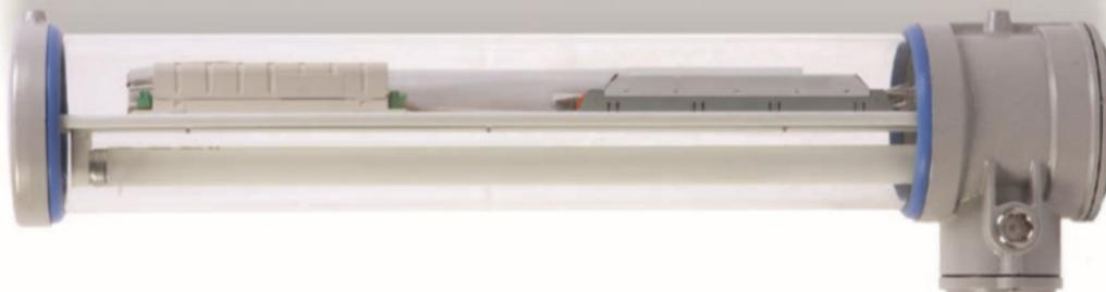
Die Rohrleuchte FLFE ist ideal für den Einsatz in explosionsgefährdeten Bereichen. Sie wurde entwickelt, um Installations- und Wartungsarbeiten zu erleichtern und zu beschleunigen. Die elektrischen Komponenten sind auf einem Geräteträger angebracht, der gleichzeitig auch als Reflektor dient und zum Lampentausch einfach herausgezogen wird.
